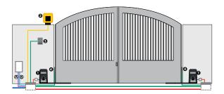
Low voltage cabling ■ 3x0,50 mm<sup>2</sup> cable 2x0,50 mm<sup>2</sup> cable
